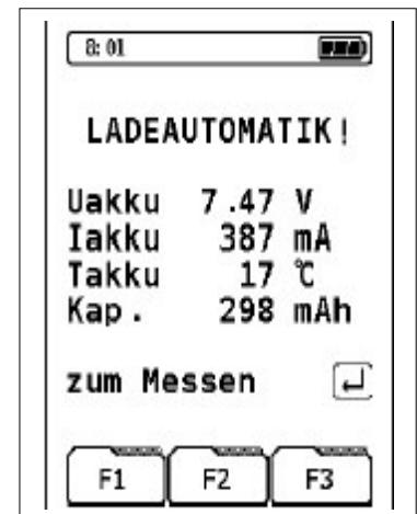
Indata ce acumulatorul este incarcat complet, aparatul comuta automat pe stare pasiva de incarcare (incarcare de mentinere), adica afisajul pentru incarcarea automata dispare. Dupa incheierea procesului (activ) de incarcare, aparatul poate ramane racordat dupa dorinta la incarcator, fara ca acumulatorul sa fie deteriorat.
